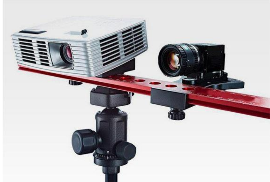
Višelinijnska triangulacija (strukturiranom svetlošću) - primeri
